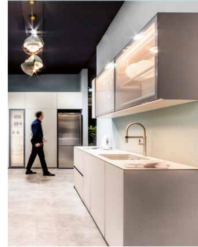
상부장 손잡이 양면 LED _ 상부장 도어에 손잡이를 만들지 않고 자판에 설치하여 손잡이 홈을 연출하며 양면으로 비춰주는 상부장 손잡이 양면 LED
