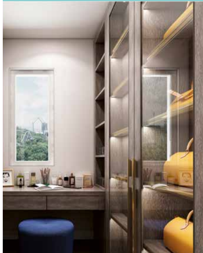
전면 선반 빛각 LED _ 선반 전면에 설치하여 가구 안쪽을 빛각으로 비춰주는 전면 선반 빛각 LED 조명
